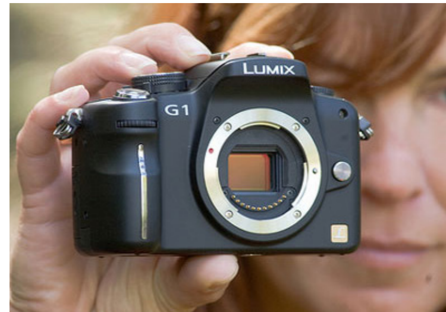
Fig.34 Panasonic Lumix G1, prima fotocamera mirrorless (2008)
