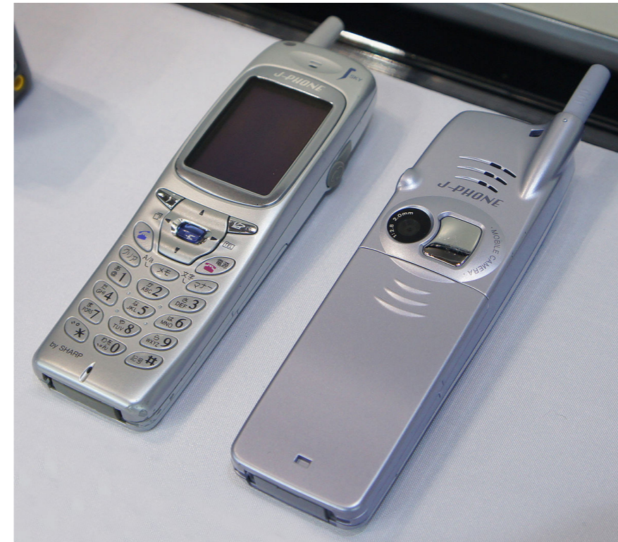
Fig.44 J-SH04, primo telefono con fotocamera integrata (2000)
