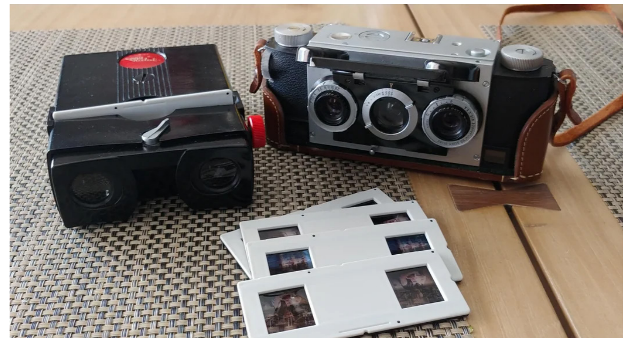
Fig.27 Stereo Realist, fotocamera stereoscopica (1947)
