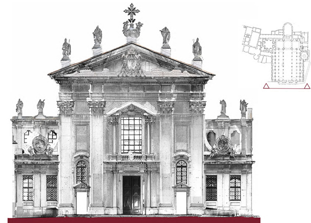
Figura 28 - Ortofoto della facciata della Cattedrale di San Pietro a Mantova generata dalla nuvola di punti, da UNESCO Research Lab di Mantova
