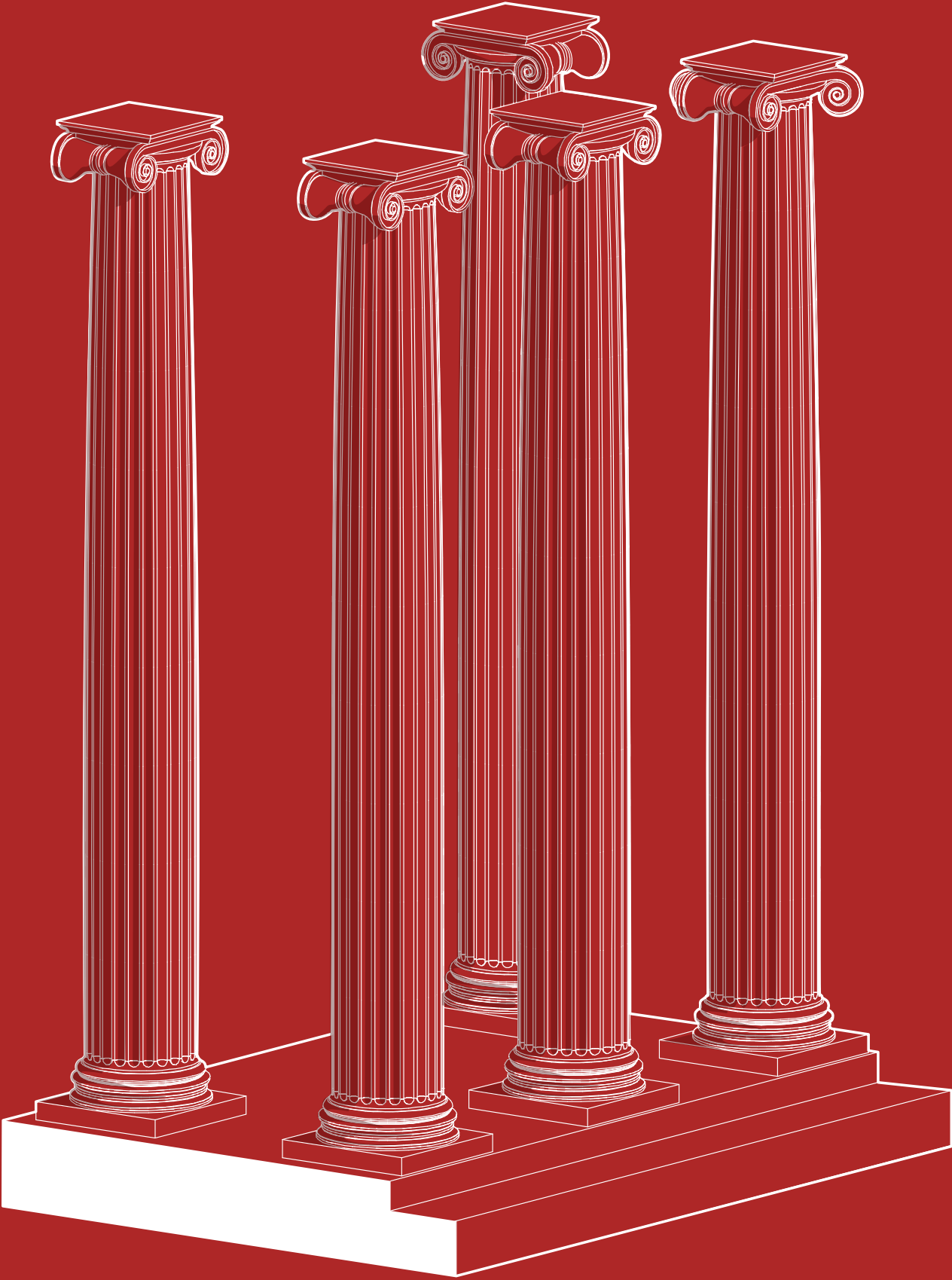
Figura 66 - Rappresentazione della colonna ionica con base efesina realizzata in ambiente BIM
