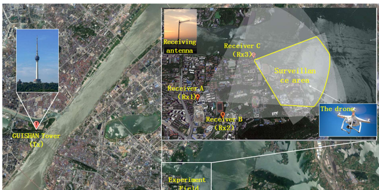
Figura 3.2: Configurazione sperimentale di un radar passivo multistatico [6].
