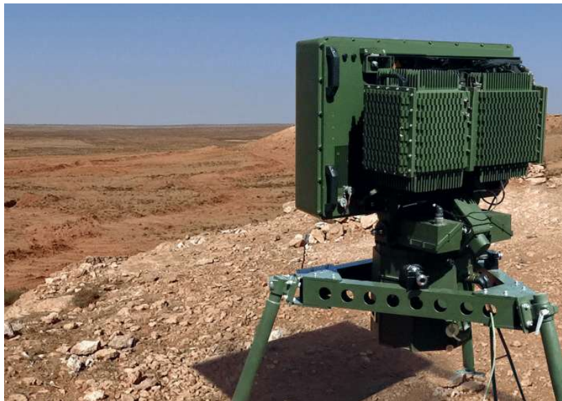
Figura 4.3: Radar AESA Spexer 2000 (Hensoldt). Sistema C-UAS in banda X utilizzato per la sorveglianza terrestre e aerea a corto e medio raggio, impiegato in ambito NATO [28].
