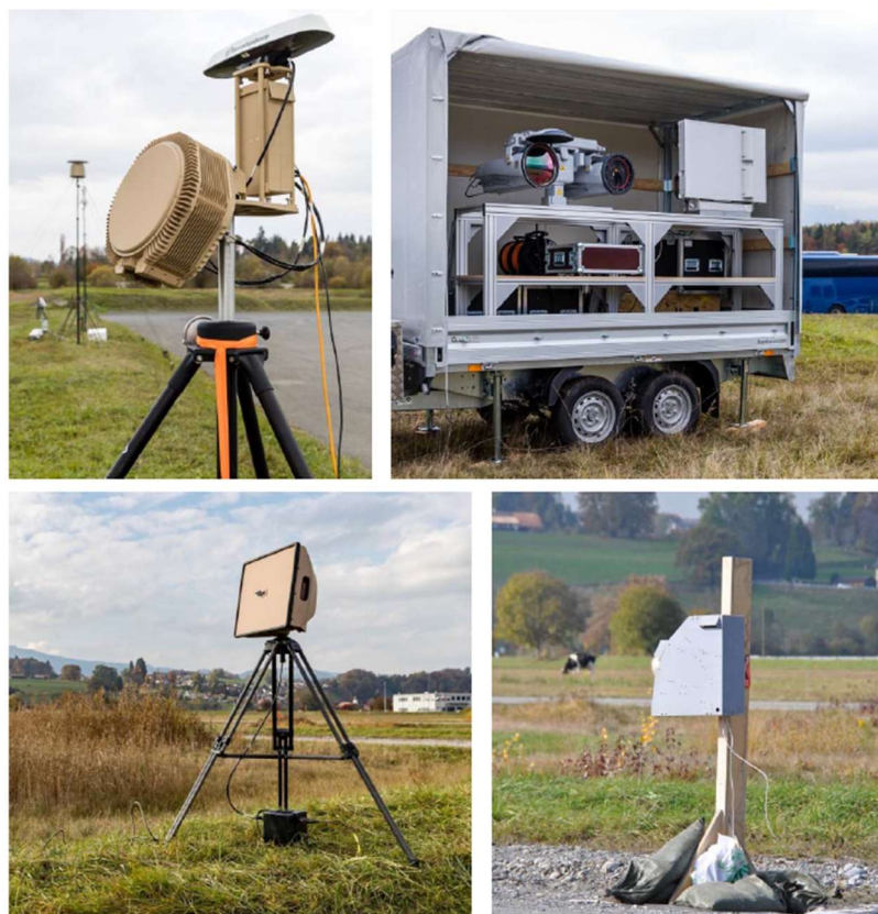
Figura 1.2: Evoluzione dei sistemi radar anti-drone. Da in alto a sinistra verso il basso a destra: radar VSHORAD RADA (banda S, Rheinmetall), radar AESA Spexer (banda X, Hensoldt), radar da campo Squire (banda X, Thales) e sistema di allarme Oerlikon Radshield (banda W, Rheinmetall) [9].
