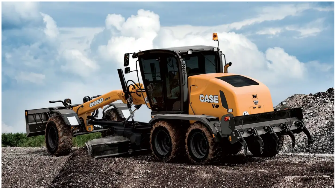
Figura 1.24: Esempio di attività operativa del grader
