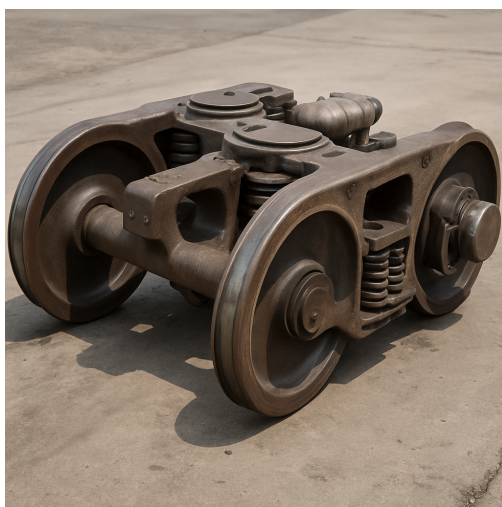
(a) Carrello tradizionale in acciaio fuso
