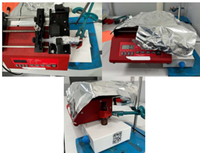
Fig 32: Configurazione pompa a siringa
