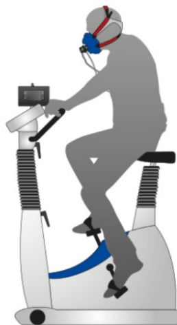
Figura 4.7: Configurazione del soggetto durante il test con il sistema metabolico COSMED K5. Figura dal manuale ufficiale COSMED [61].
