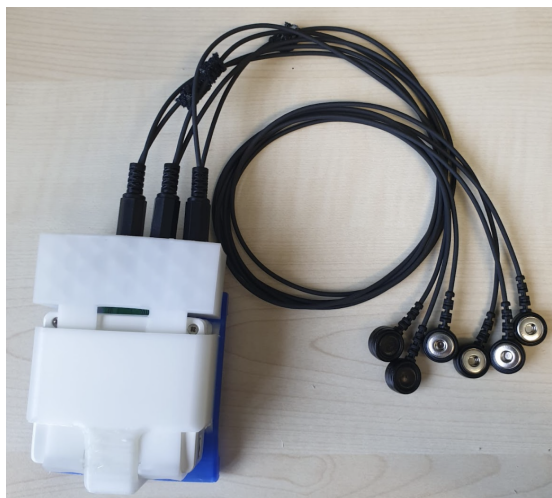
Figura 4.2: Supporto in stampa 3D progettato per l'alloggiamento del dispositivo MotemaSens [62][63].
