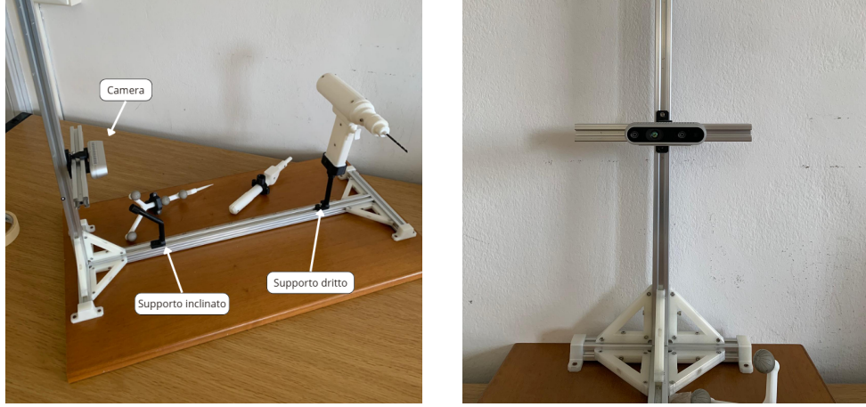
(a) Struttura del supporto, strumenti analizzati, attacco dritto e inclinato. (b) Struttura per il posizionamento della camera.
