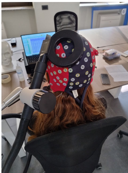
Figura 4.14: Set-up sperimentale delle prove sul soggetto, con bobina centrata sull'elettrodo C3.
