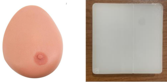
Figura 3.1: Rappresentazione dei fantocci utilizzati. A sinistra è mostrato il fantoccio 3B Scientific Breast, mentre a destra è visibile il fantoccio in PDMS con emulsione.
