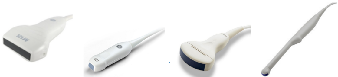
Figura 1.2: Tipologie di sonde ecografiche. Da sinistra verso destra: lineare, phased array, convex, microconvex.
