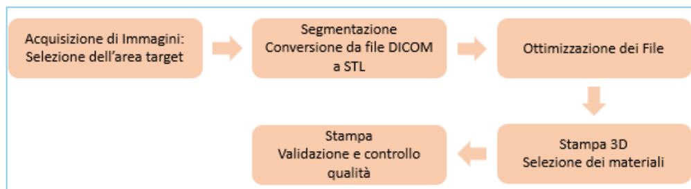
Figura 2.4 Schema di lavoro della stampa 3D
