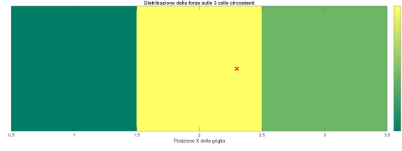
Figure 3.6: Distribuzione della forza di un nodo lagrangiano su una griglia fluida. Il nodo della membrana (indicato con una x ) si trova in posizione x = 2.3 . La forza F_{\text{elastic}} = 10 N viene distribuita sulle prime tre celle della griglia secondo la funzione delta regolarizzata \delta_h , con pesi 0, 0.7 e 0.3, rispettivamente
