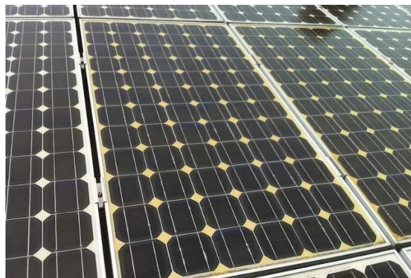
Figura 2.8: Invecchiamento e ingiallimento dell'EVA 13
