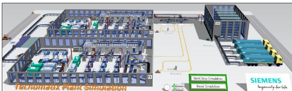
Figura 1.1. Esempio di modello DES di una linea di produzione completa.
