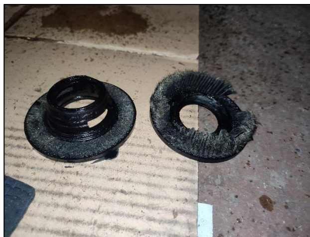
Figura 8: Filtri Blow-by deboli strutturalmente
