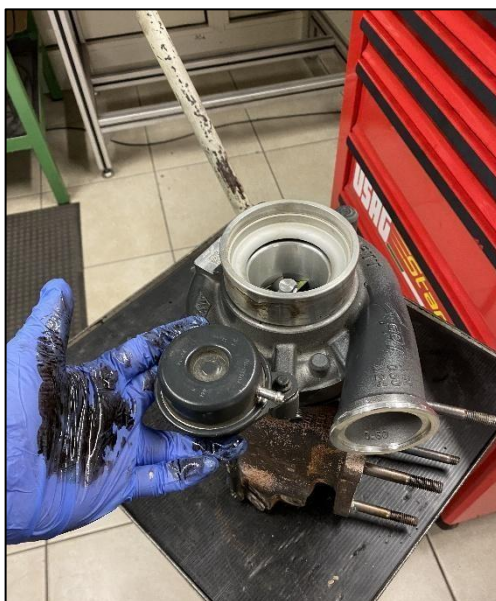
Figura 9: Analisi su turbina fallita ritornata dal campo
