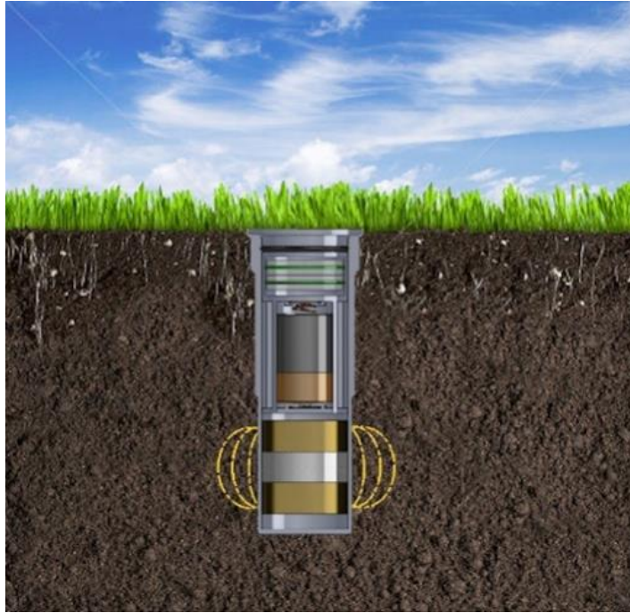
Figura 3: Sensore che monitora l'umidità del terreno. Fonte: https://www.etgsrl.it/prodotti/sensore-umidita-terreno-imoisture/
