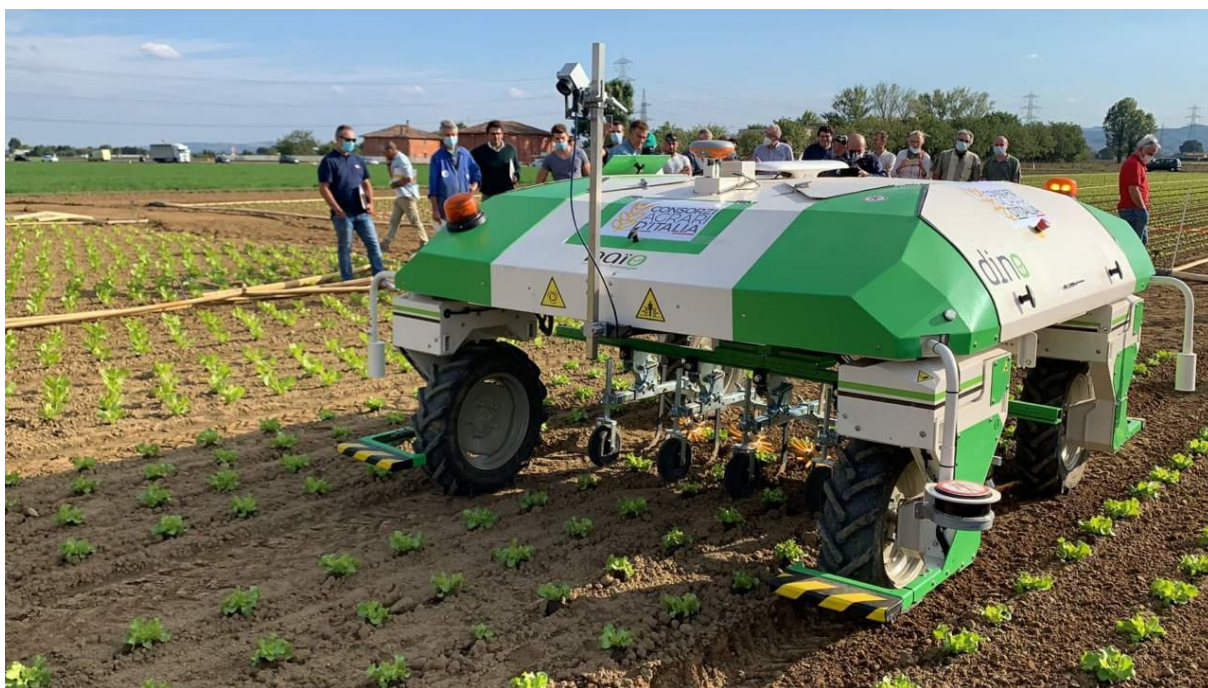
Figura 7: Robot autonomo in grado di diserbare meccanicamente le orticole. Fonte:
