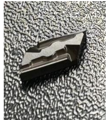
Figura 13: Inserto da taglio (caso studio) ed esempio di superficie NURBS.
