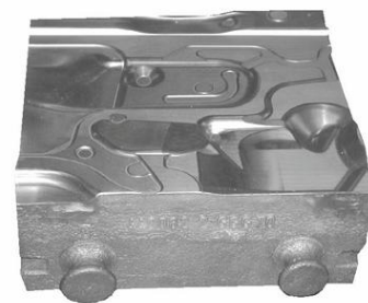
Figura 3: Parte di uno strumento di formatura della lamiera con elementi liberi
