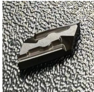
Figura 42: Inserto da taglio per tornitura [16].
