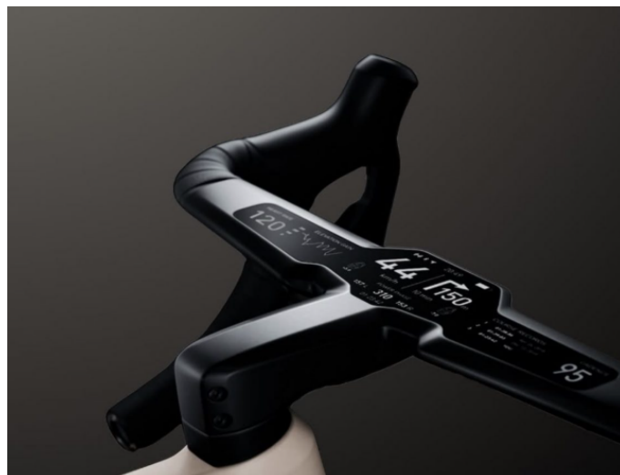
Figura 4.4: Flitedeck, il manubrio con display integrato
