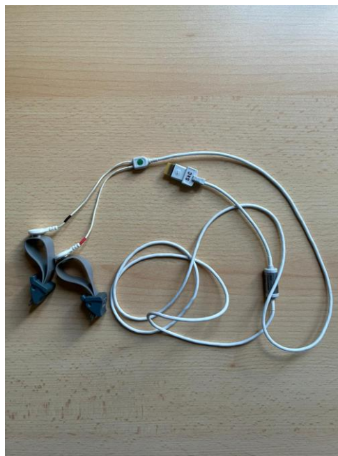
Fig 2.7 Sensori per l'acquisizione dell'EDA
