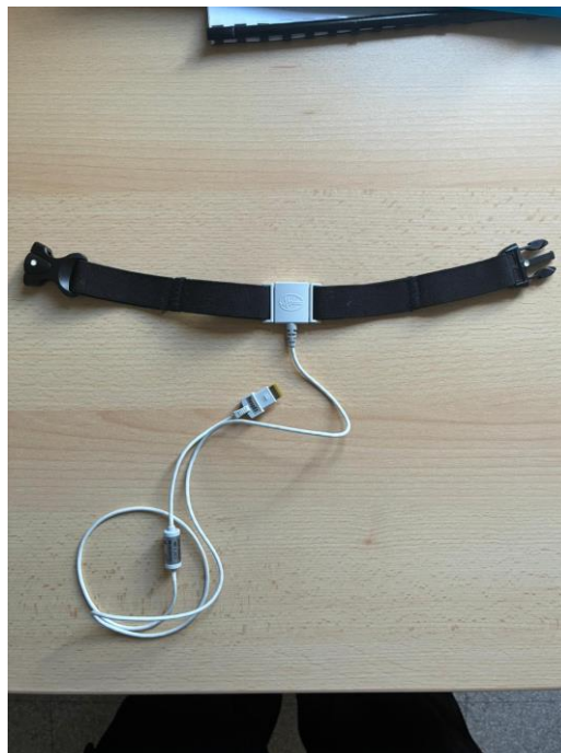
Fig 2.8 Fascia toracica per l'acquisizione del segnale respiratorio
