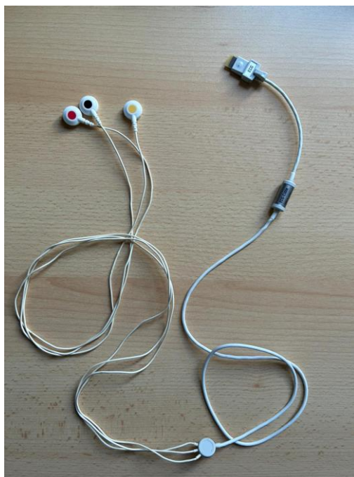
Fig 2.6 Elettrodi per l'acquisizione del segnale ECG
