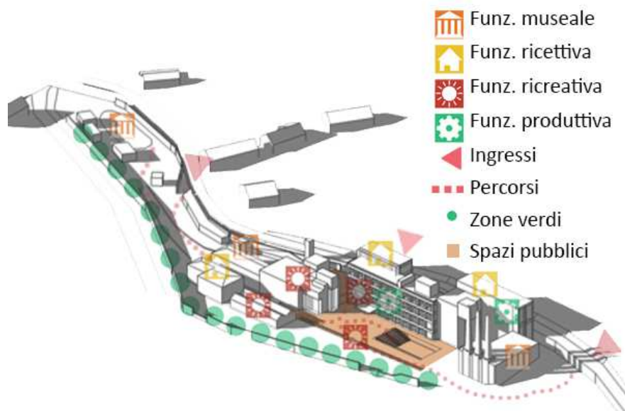
Masterplan dell'area di progetto con ripartizione generale delle funzioni
