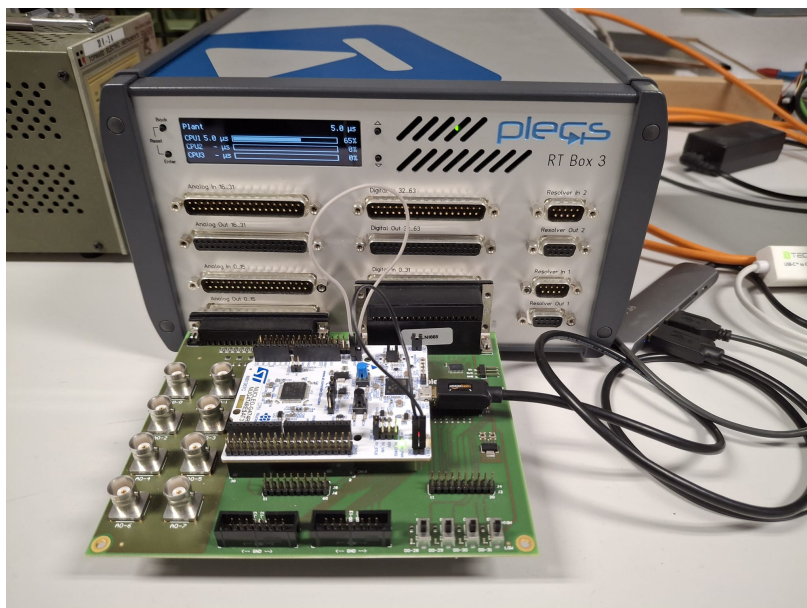
Figura 5.3: RT Box 3 e scheda Nucleo G474RE.
