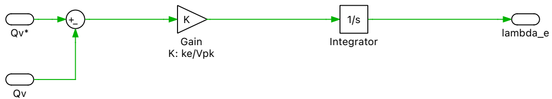
Figura 4.21: blocco dell'eccitazione del VSG.
