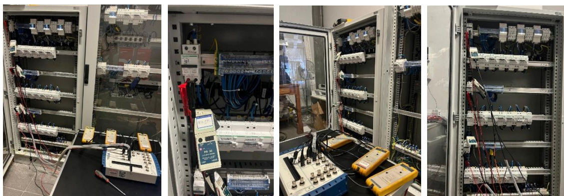
Figura 4.3: Montaggio ed esecuzione delle misure sperimentali sul quadro
