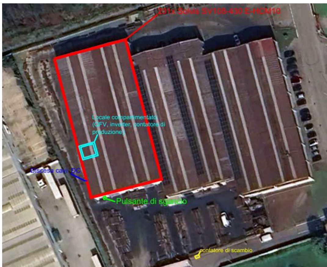
Figura 52: Il tetto interessato dal progetto è evidenziato in rosso. Viene indicata la posizione del locale compartimentato, della discesa cavi, del pulsante di sgancio e del contatore di scambio.
