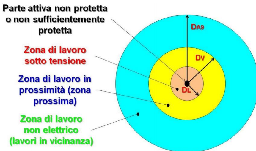
Figura 38: Zone di lavoro come definite dalla norma CEI 11-27.
