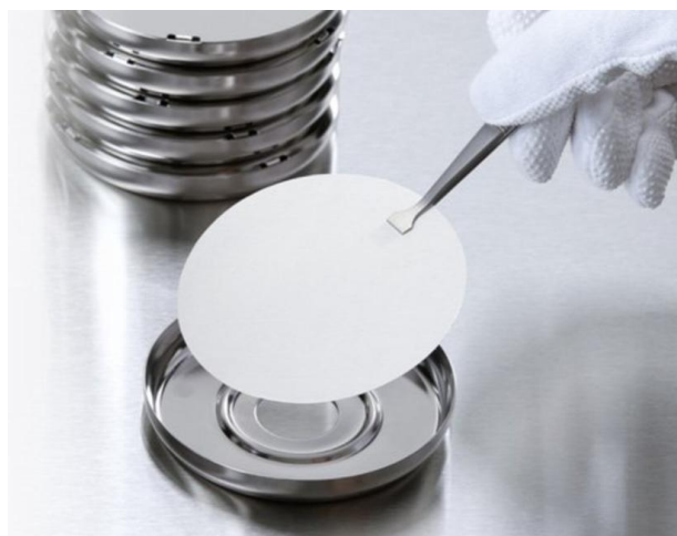
Fig. 04. Filtro utilizzato per la determinazione della concentrazione di particolato fine con metodo gravimetrico 24
