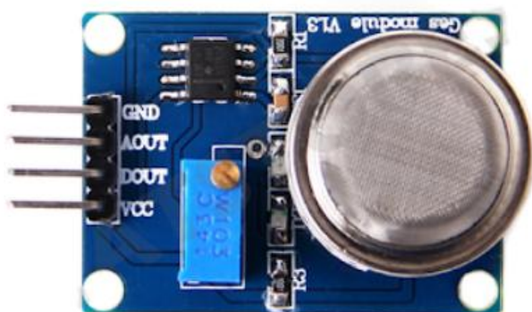
Fig. 10. Sensore di gas NO_2 con collegamenti 41
