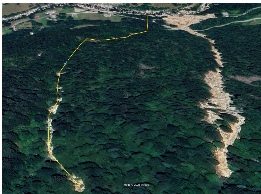
Figura 128: Possibile percorso del secondo debris flow
