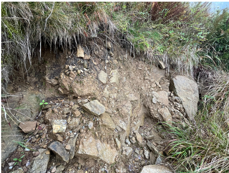
Figura 52: Granulometria e morfologia del materiale costituente la copertura dell'area di distacco
