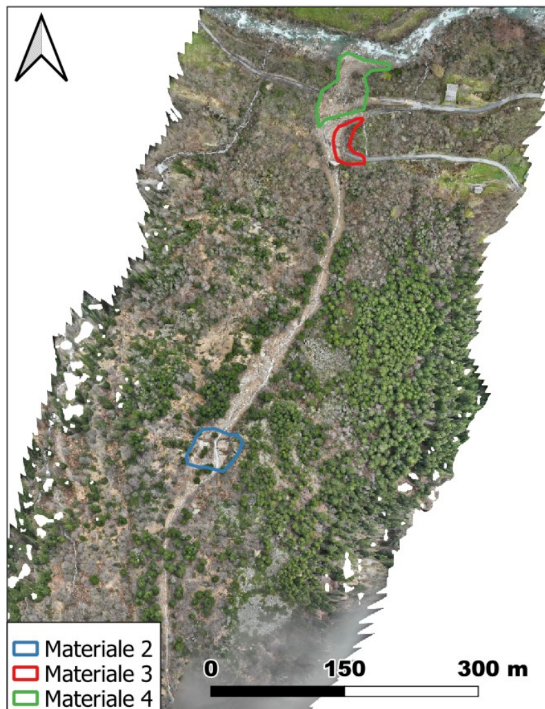
Figura 112: Distribuzione dei materiali aggiunti alla topografia: materiale 2 in blu per simulare il salto roccioso, materiale 3 in rosso per considerare la strada e il masso ciclopico e infine il materiale 4 per il fondo
