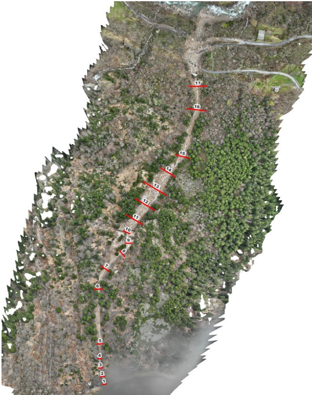
Figura 91: Sezioni (1-17) distribuite lungo il secondo tratto del canale, utili alla ricostruzione della topografia e alla stima del volume accumulato al fondo
