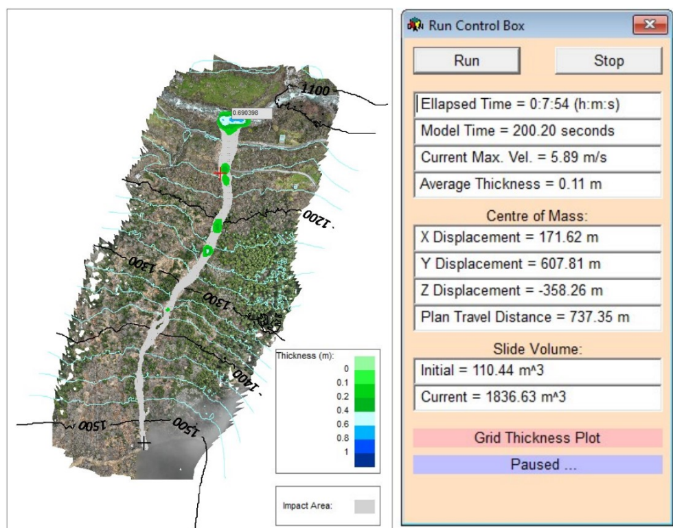
Figura 79: Distribuzione spaziale degli accumuli
