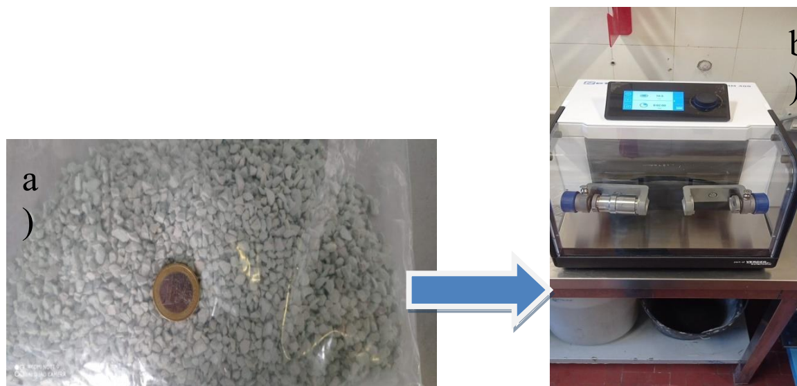
Fig 5.1 a) Clinoptilolite grezza b) mulino a sfere utilizzato per macinare la clinoptilolite
