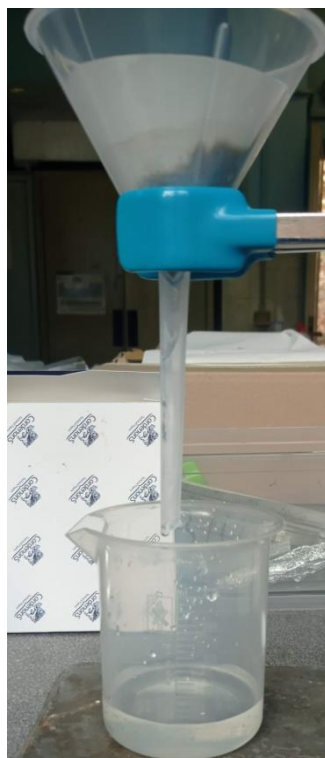
Fig 6.17 filtraggio della soluzione clinoptilolite funzionalizzata + soluzione di Cu La soluzione a base di Cu, passa da un colore blu, ad incolore dopo la filtrazione
