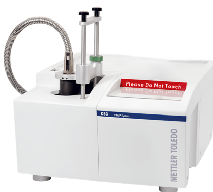
Figura 2.8: Il calorimetro "Mettler Toledo DSC-1™" usato per l'analisi foto-DSC delle resine.
