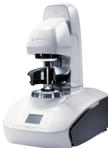
Figura 2.13: Lo strumento "Anton Paar MCR 302e™" usato per l'analisi di rilassamento degli sforzi.
