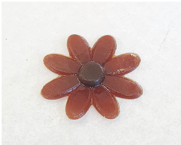
Figura 3.26: Il campione stampato con la formulazione ECO-ESO_70-30_EUGP che ha mostrato con successo proprietà di self healing, rimarginando un taglio praticato con una lametta da rasoio.
