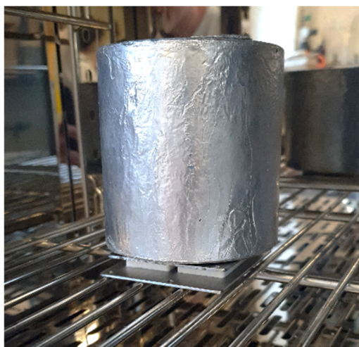
Figura 2.16: Riprocessamento termico di un campione nello stampo a forma di osso di cane.
