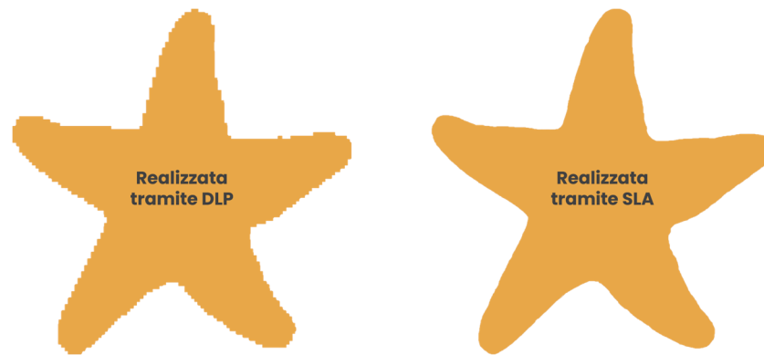
Figura 1.21: Confronto del livello di dettaglio nel piano XY ottenibile tramite DLP (a sinistra) e tramite SLA (a destra).
