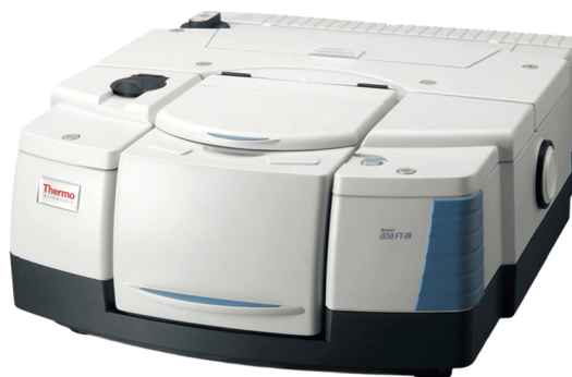
Figura 2.6: Lo spettrometro "Thermo Scientific Nicolet iS50 FT-IR™" usato per le analisi FT-IR delle resine.
