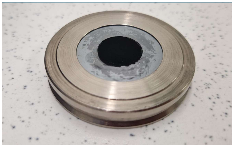
Figura 29. Collocazione delle polveri essiccate nella cavità di un portacampione piatto utilizzato per effettuare l'analisi XRD.
