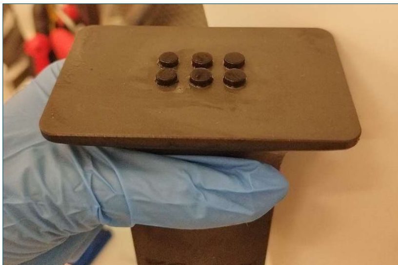
Figura 27. Disposizione dei 6 cilindri di f\text{-MoS}_2\text{/PEGDA/MCH-3DP} sulla piattaforma di stampa.
