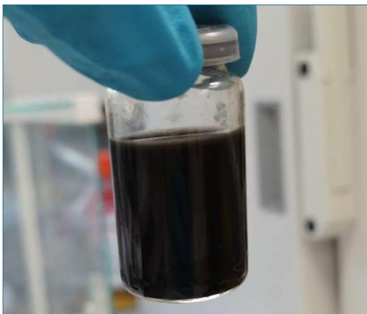
Figura 40. Colorazione nera della formulazione fotoreticolabile contenente il f\text{-MoS}_2 .
