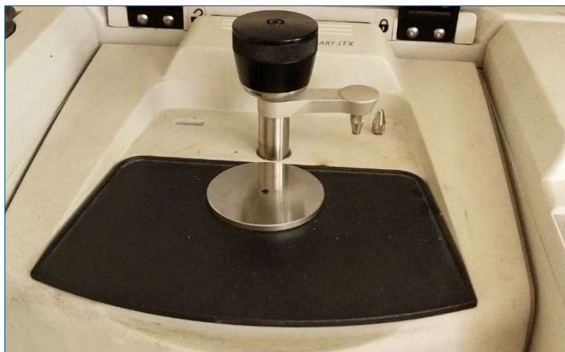
Figura 30. Disposizione del campione sul cristallo di diamante dell'accessorio ATR dello spettrofotometro FTIR Thermo Scientific Nicolet iS50.
