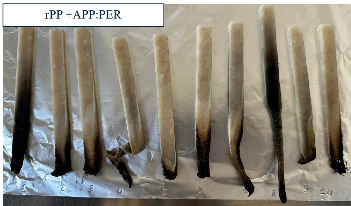
Figura 58. Residui del test UL-94 di rPP+APP:PER
