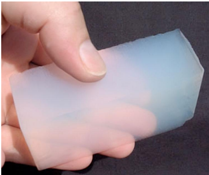
Figura 1.1: Esempio di un aerogel monolitico, da notare la parziale trasparenza e la tinta azzurra [5]
