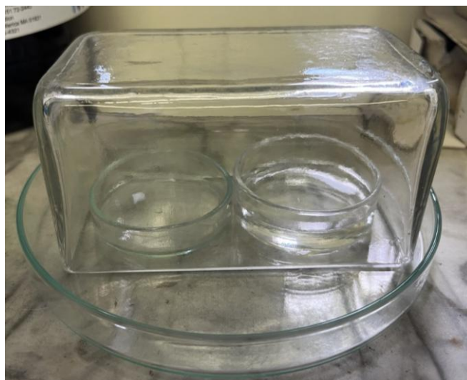
Figura 3.5: Equipaggiamento utilizzato per saturare l'aerogel (contenitore a sinistra) con acqua (contenitore a destra)
