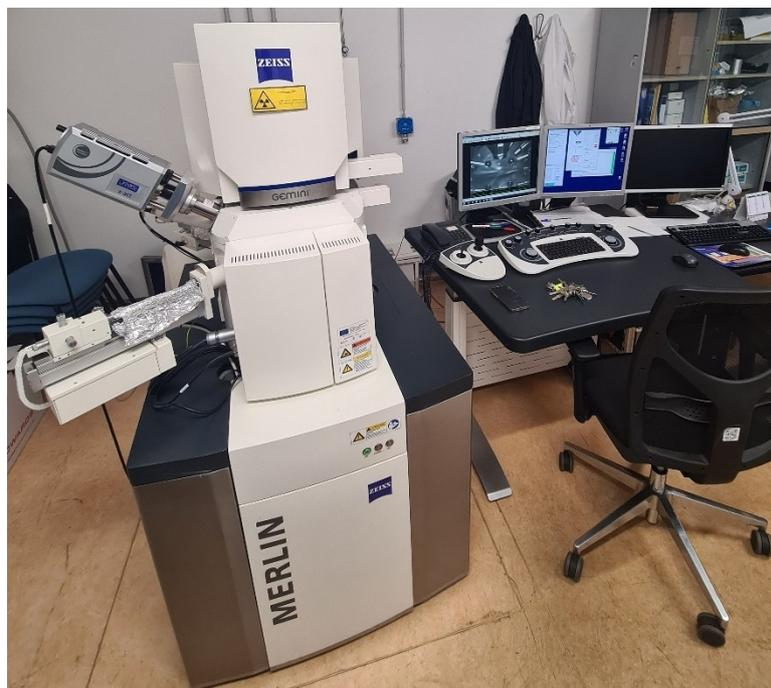
**Figura 4.5:** Microscopio elettronico ad emissione di campo ZEISS Merlin utilizzato per le analisi FESEM degli aerogel sintetizzati.
