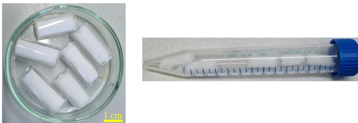
**Figura 5.4:** Fasi conclusive della sintesi sol-gel “3gg\_10%\_CD”: a sinistra i monoliti ottenuti all'interno dei cilindretti al termine dell'essiccamento supercritico, a destra i campioni di aerogel trasferiti in provetta e destinati alle successive analisi di caratterizzazione.
