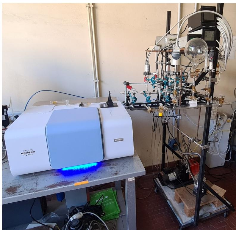
**Figura 4.4:** Strumento Bruker Equinox 55 utilizzato per l'analisi FT-IR dei campioni di aerogel.
