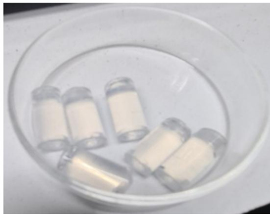
**Figura 5.1:** A sinistra, il sistema al termine della fase di gelificazione; a destra, i cilindretti di vetro con il gel al termine della fase di invecchiamento.
