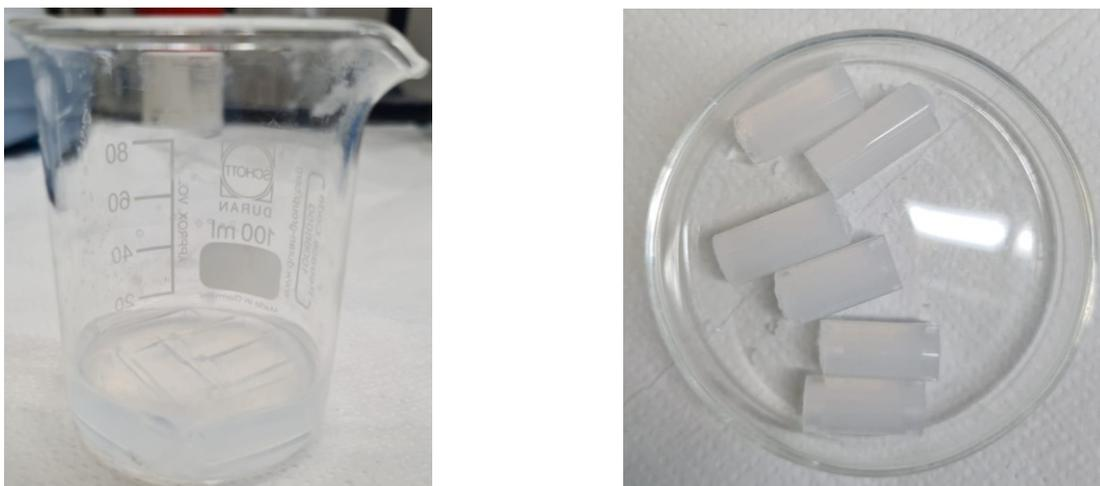
**Figura 5.9:** A sinistra, il sistema osservato alla conclusione della gelificazione; a destra, i cilindretti contenenti il gel dopo il periodo di invecchiamento condotto in 2-propanolo.
