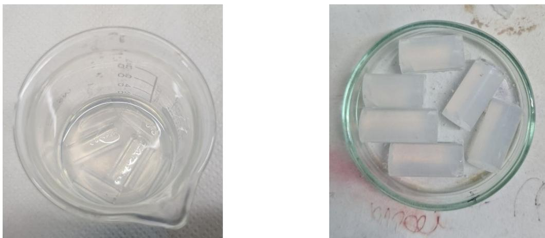
**Figura 5.3:** Fasi della sintesi sol-gel “3gg\_10%\_CD”: a sinistra la fine della gelificazione, a destra i cilindretti contenenti il gel al termine della fase di invecchiamento.
