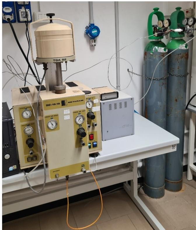
**Figura 4.2:** Strumento STA Linsesis utilizzato per le TGA dei campioni di aerogel.
