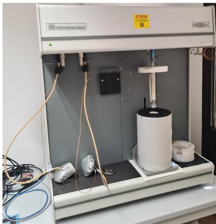
**Figura 4.3:** Strumento ASAP 2020 Plus Micromeritics utilizzato per le analisi di adsorbimento-desorbimento di azoto.
