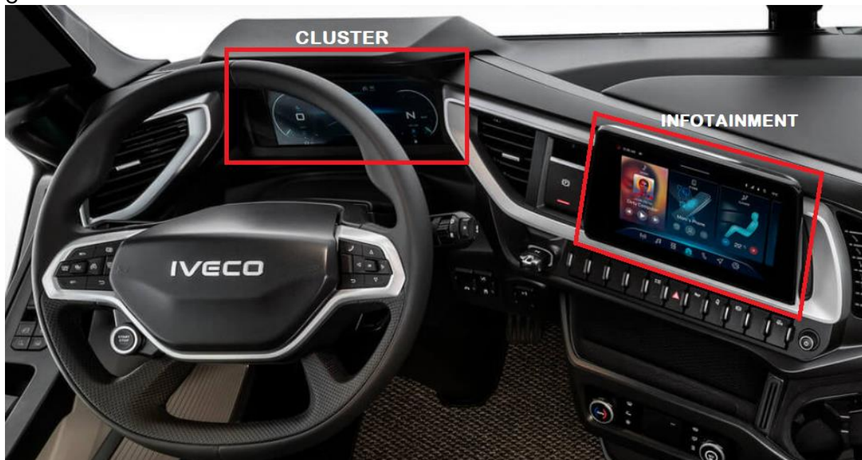
Figura 1 Cluster, infotainment ed indicatori/comandi vari di un trattore stradale Iveco S-Way
