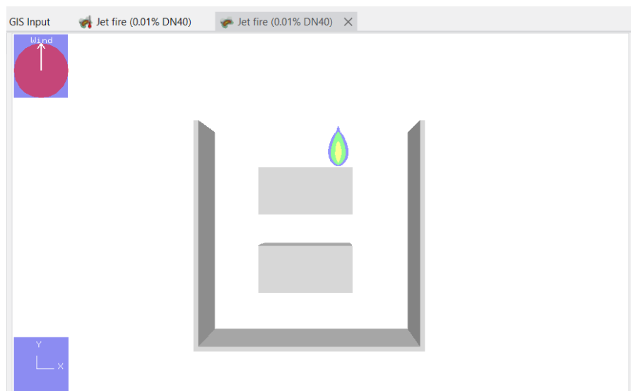
Figura 99: Proiezione livelli di irraggiamento termico, vista dall'alto, 0.01% DN 40, immagine tratta da PHAST
