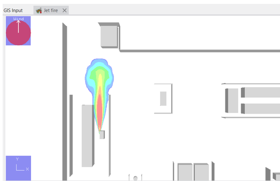
Figura 86: Proiezione livelli di temperatura, vista dall'alto, 100% DN 6, immagine tratta da PHAST
