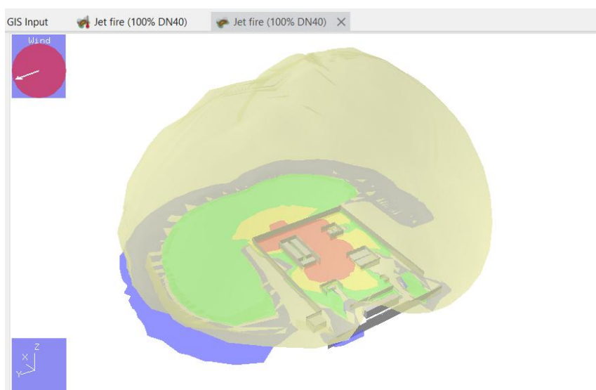
Figura 116: Superficie isovalore e proiezione livelli di irraggiamento termico, vista tridimensionale, 100% DN 40, immagine tratta da PHAST
