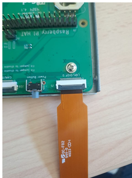
Figura 5.5: Collegamento Picamera Module 3 lato Raspberry
