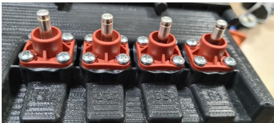
*Figura 3.12 Dettaglio della deformazione della guarnizione sui connettori a un polo*
