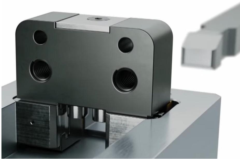
*Figura 5.4 Dettaglio del tassello che si trova nella seconda piastra cavità*
