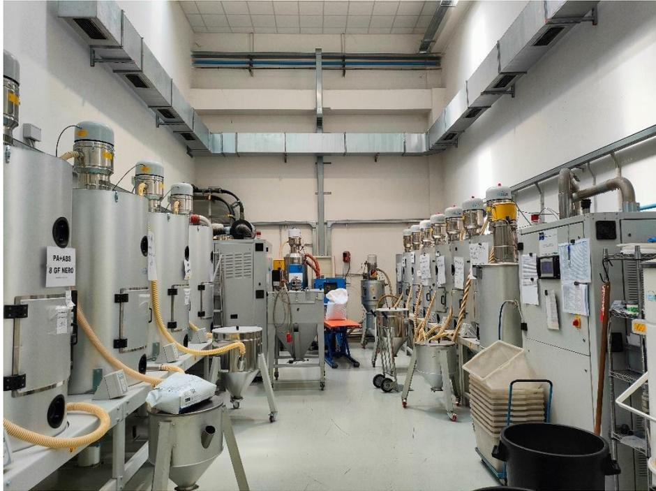
*Figura 2.6 Silos e deumidificatore presenti in Merlo*
