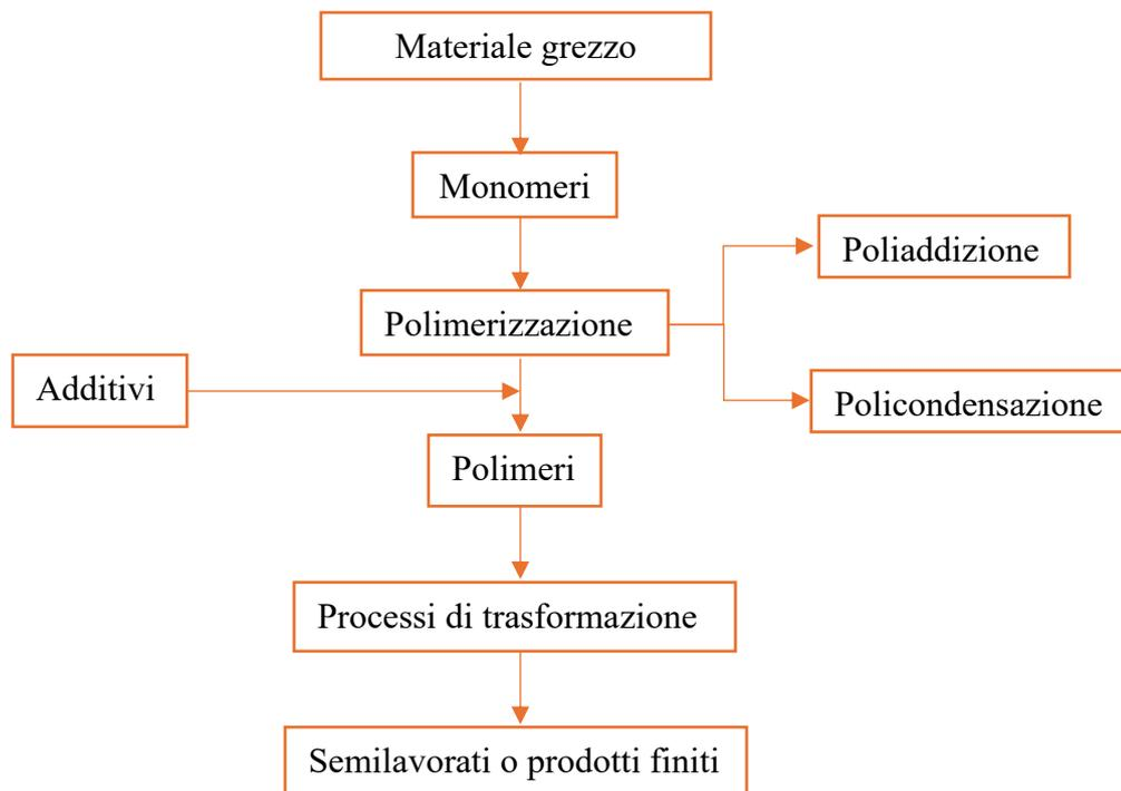
*Grafico 2.1 Schema logico del processo produttivo di componenti polimerici*
