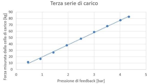
Figura 6.17: Terza serie di carico calibrazione cilindro freno
