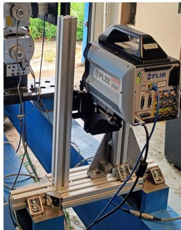
Figura 5.17: Termocamera montata sul supporto
