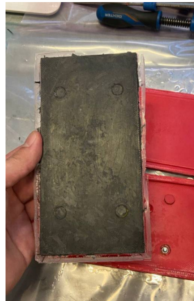
Figura 3.6: Piastra estratta dallo stampo subito dopo l'indurimento della resina
