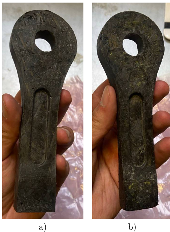
Figura 7.17: Bielletta finale: a) 124 faccia superiore del componente a contatto con lo stampo superiore; b) faccia inferiore.
