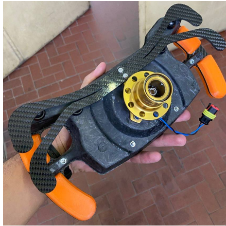
Figura 3.1: Backplate un volante realizzato in carbon forged usando scarti di lavorazione di tessuto in fibra di carbonio
