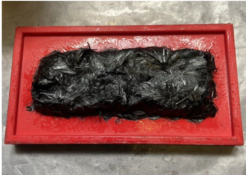
Figura 3.5: Posizionamento dell'impasto di fibra e resina nello stampo
