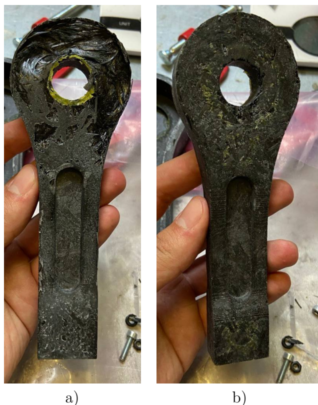
Figura 7.16: Primo prototipo di bielletta: a) faccia superiore del componente, in contatto con lo stampo superiore; b) faccia inferiore in contatto con lo stampo inferiore.
