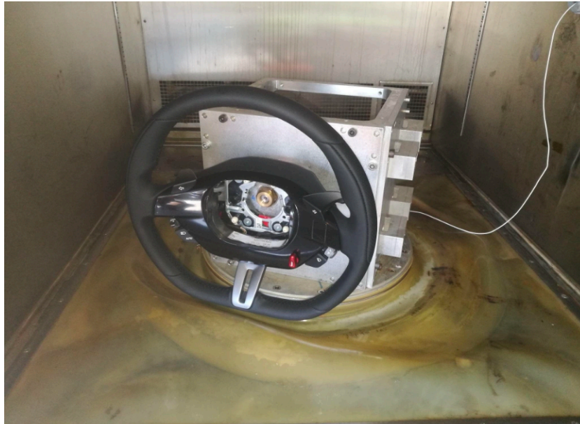
Figura 3.1.3- SC montato sullo shaker con piastra per volante
