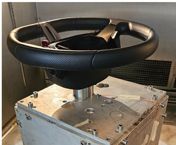
Figura 13.2.1– Accelerometro posizionato al centro della piastra
