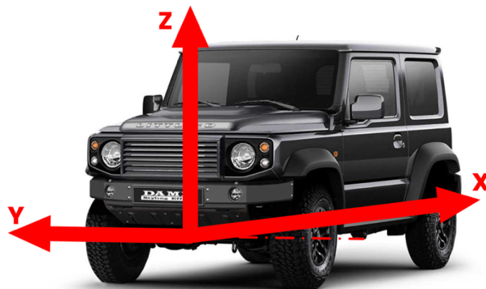
Figura 3.1.4- Sistema di riferimento automotive [4]
