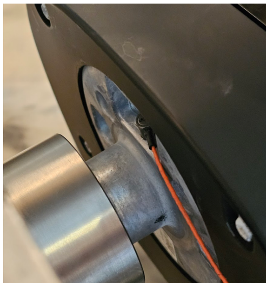
Figura 13.3.2– Posizionamento accelerometro sul volante laterale
