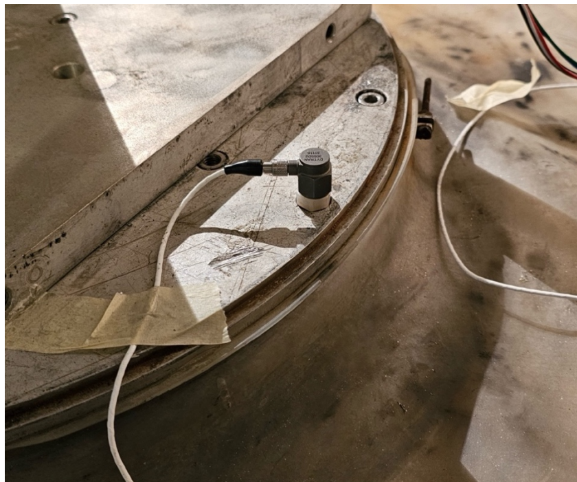
Figura 6.2.5- Posizionamento accelerometro alla base dello shaker
