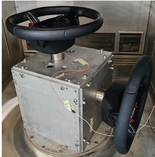
Figura 13.3.1– Set-up della prova con accelerometro fissato sul mozzo superiore
