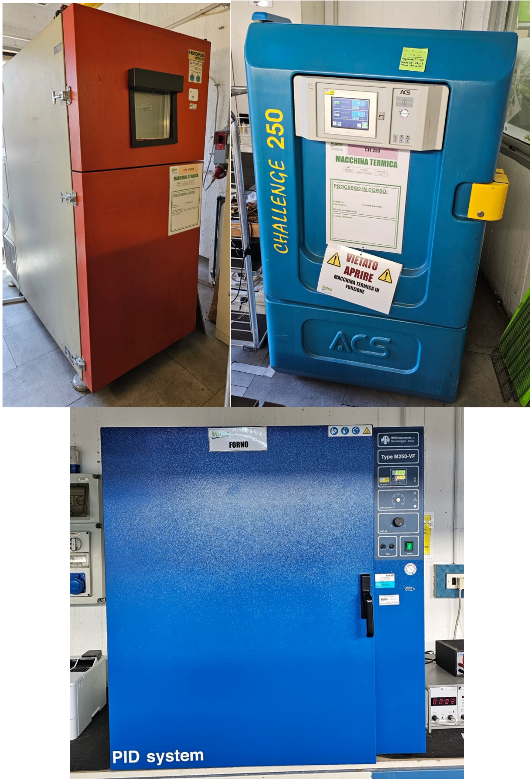
Figura 2.1.1– Esempi di camera climatiche e forno
