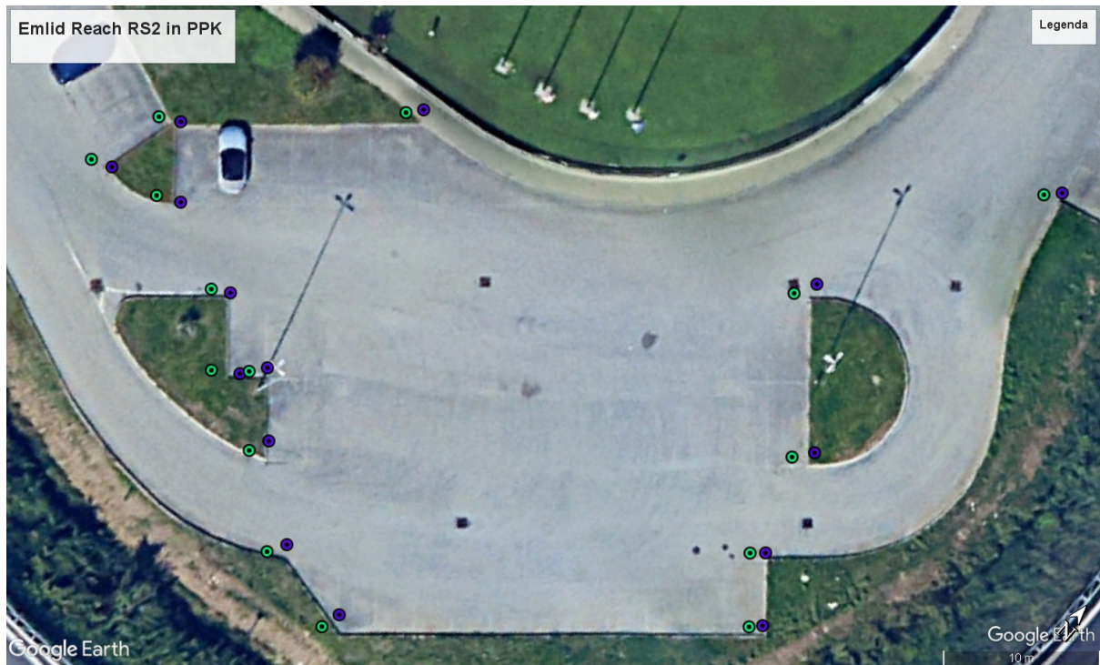
Figura 3.2: Punti campionati con il ricevitore Emlid corretti con SPIN3 in PPK (in verde) e punti grzzi non corretti (in viola)
