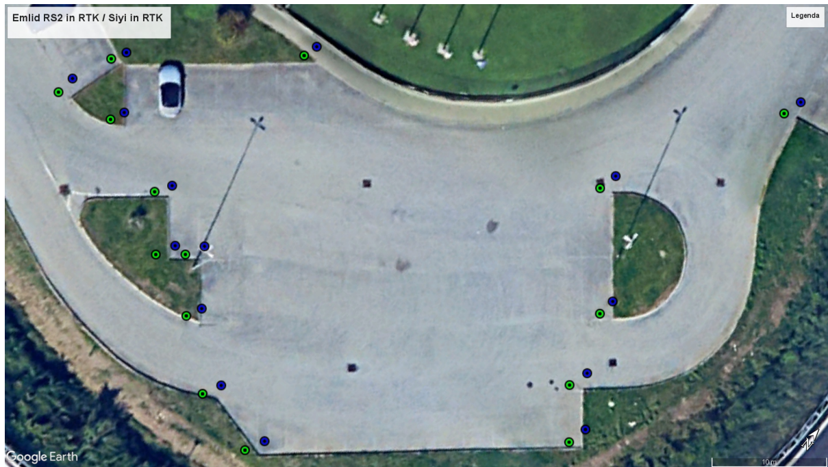
Figura 3.7: Punti campionati con il ricevitore Emlid (in verde) e con il ricevitore Siyi in RTK (in blu)
