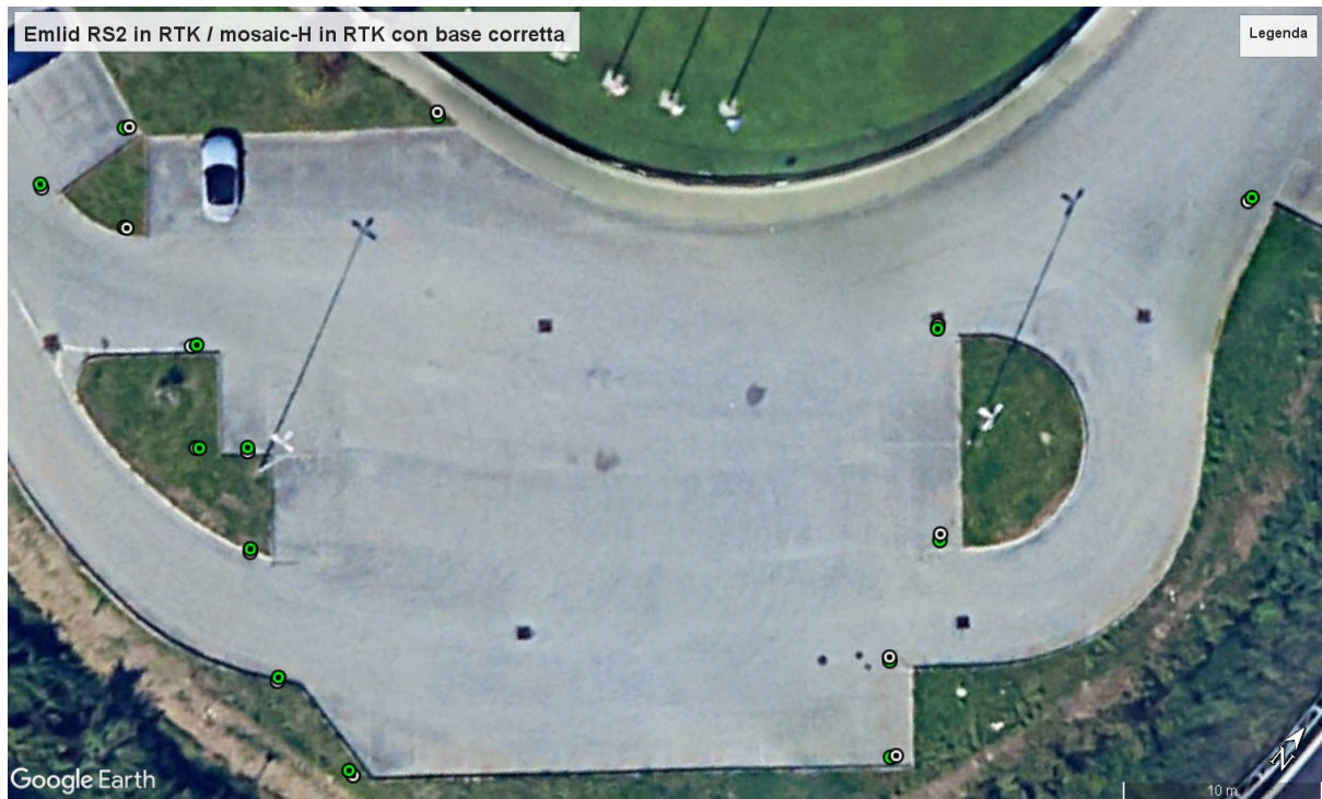
Figura 3.5: Punti campionati con il ricevitore Emlid (in verde) e con il ricevitore mosaic-H in RTK con base corretta (in bianco)
