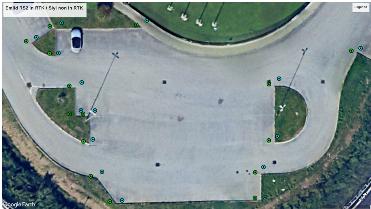
Figura 3.6: Punti campionati con il ricevitore Emlid (in verde) e con il ricevitore Siyi non in RTK (in azzurro)
