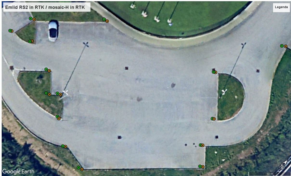
Figura 3.4: Punti campionati con il ricevitore Emlid (in verde) e con il ricevitore mosaic-H in RTK (in arancione)
