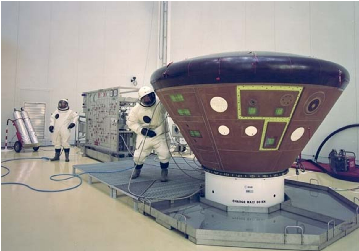
Figura 1: Rifornimento di un dimostratore per il rientro atmosferico con idrazina da [5a]
