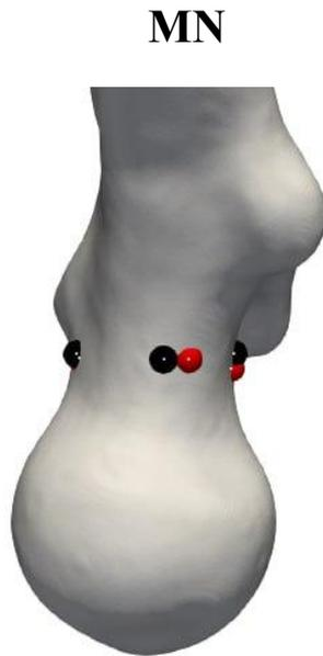
Figura 22: Femore Left #1, visualizzazione degli estensimetri sperimentali (rosso) e di quelli ottenuti su Matlab (nero) per la regione del collo femorale. AN, lato anteriore; MN, lato mediale; PN, lato posteriore.
