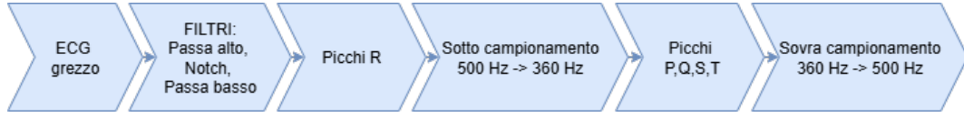
Figura 3.2: Pipeline del pre-processing e della individuazione degli eventi.
