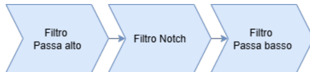
Figura 3.6: Operazioni di filtraggio: filtro Passa-alto, filtro Notch, filtro Passa-basso.
