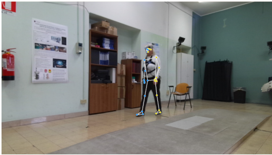
Figura 4.2: Esempio di ricostruzione dello scheletro con MediaPipe (vista slave )
