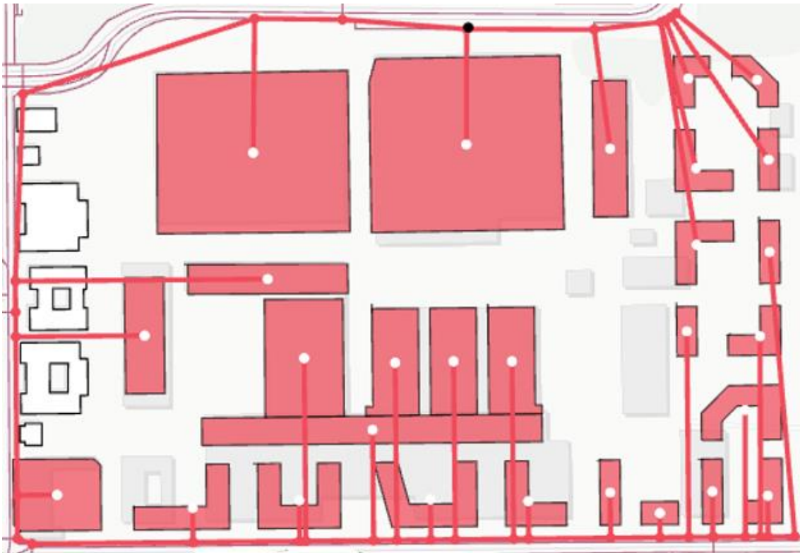
Figura 13. Layout della rete termica visualizzato in CEA
