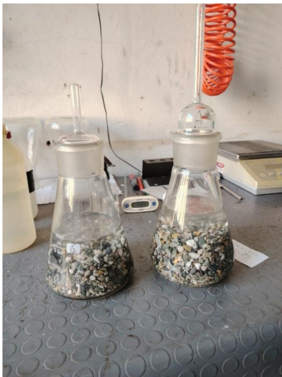
Figura 23. Sedimentazione degli aggregati
