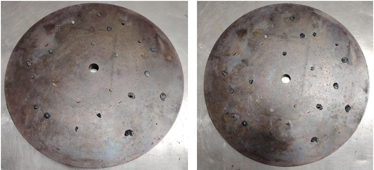
Figura 36. Trattamento termico R a 250°C pre-schiacciamento (a) e post-schiacciamento (b)
