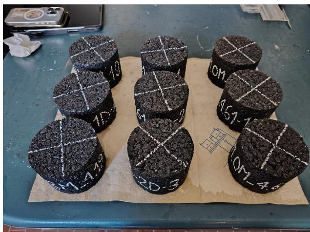
Figura 101. Campioni su piano dopo il condizionamento di 72 ore
