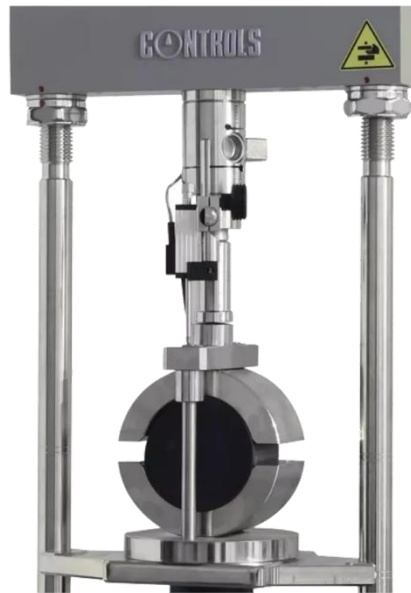
Figura 11. Dispositivo per test di Marshall stability e flow [27]
