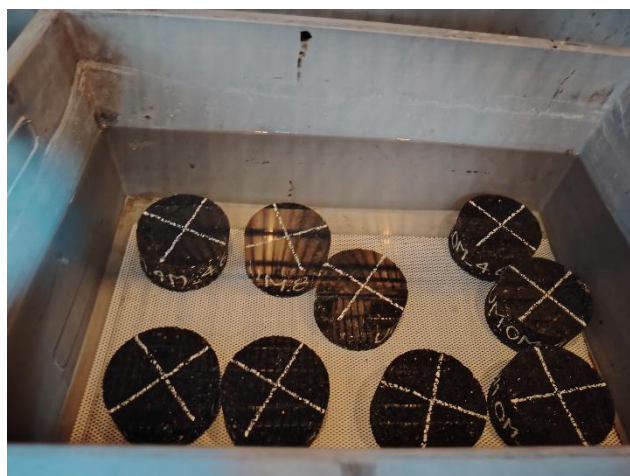
Figura 100. Condizionamento dei campioni in acqua alla temperatura di prova
