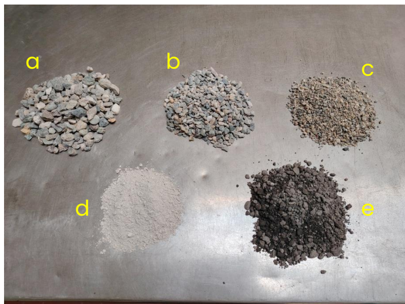
Figura 21. Classe 5/17 (a), 3/8 (b), 0/5 (c), filler (d), RAP 0/6 (e)
