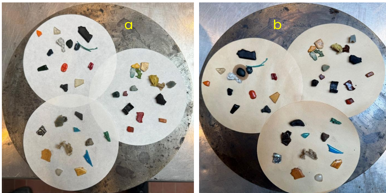
Figura 33. Trattamento termico M a 225°C pre-schiacciamento (a) e post-schiacciamento (b)
