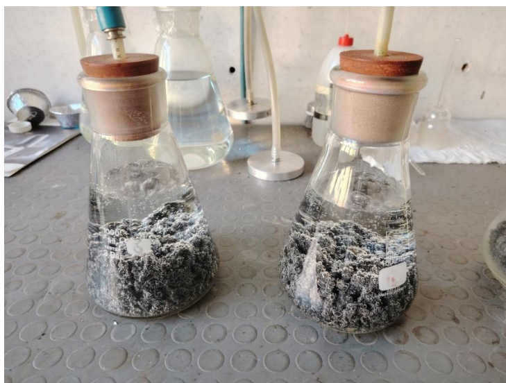
Figura 46. Deaerazione del conglomerato bituminoso
