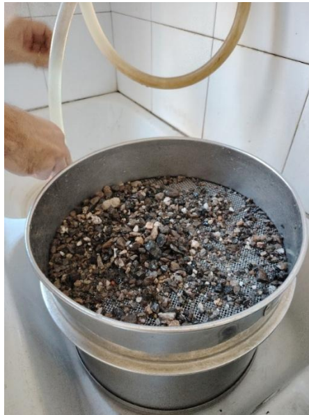
Figura 24. Lavaggio degli aggregati
