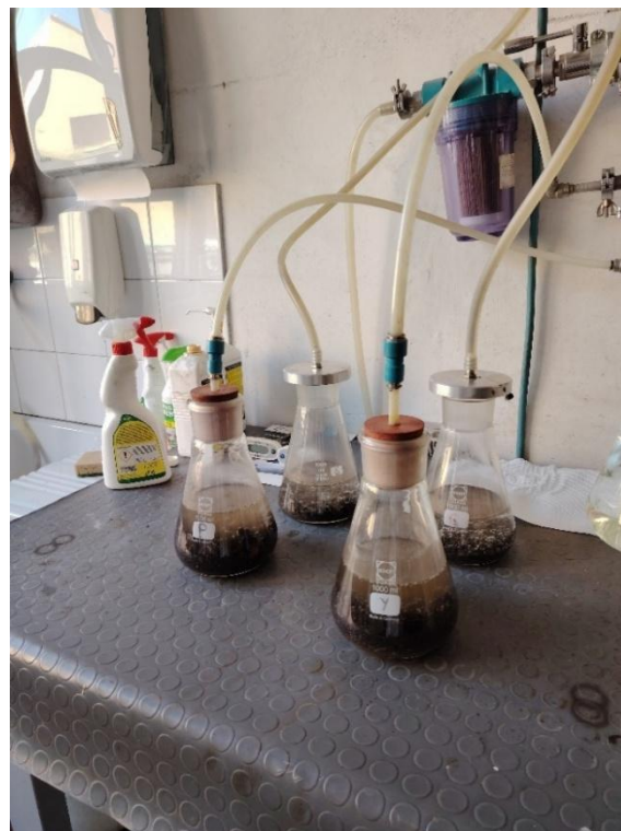
Figura 22. Deaerazione mediante disaeratore
