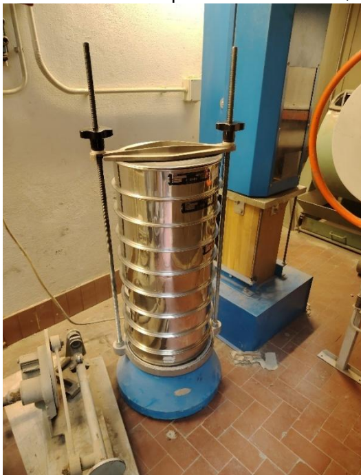
Figura 25. Pila di setacci su setacciatore meccanico
