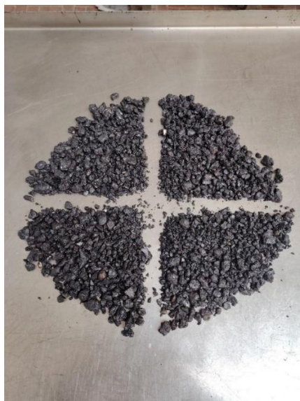
Figura 45. Quartatura del conglomerato bituminoso
