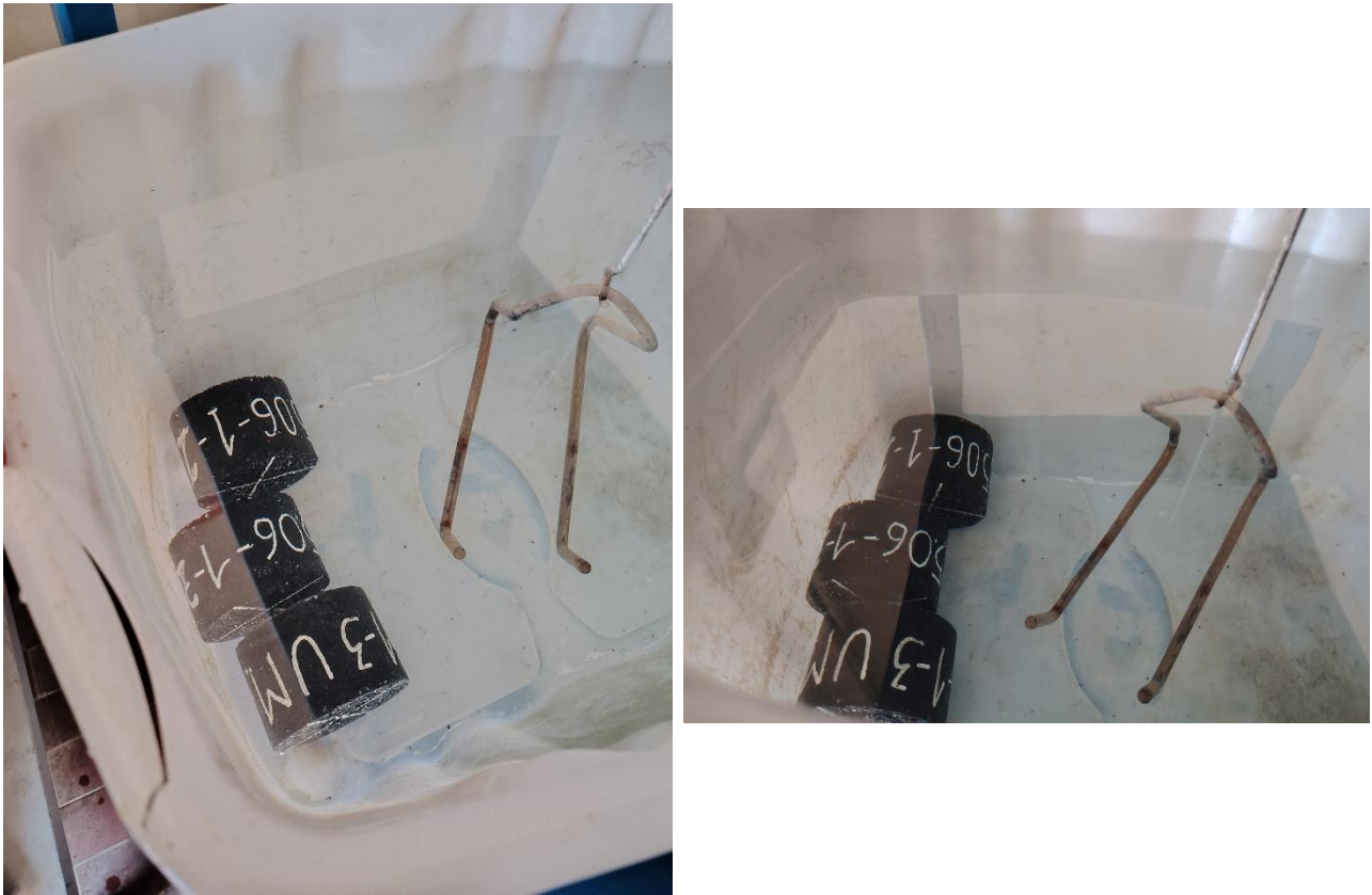
Figura 55. Campioni in acqua per successiva pesatura
