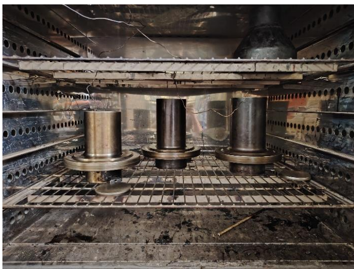
Figura 52. Preparazione fustelle in forno a 155°C
