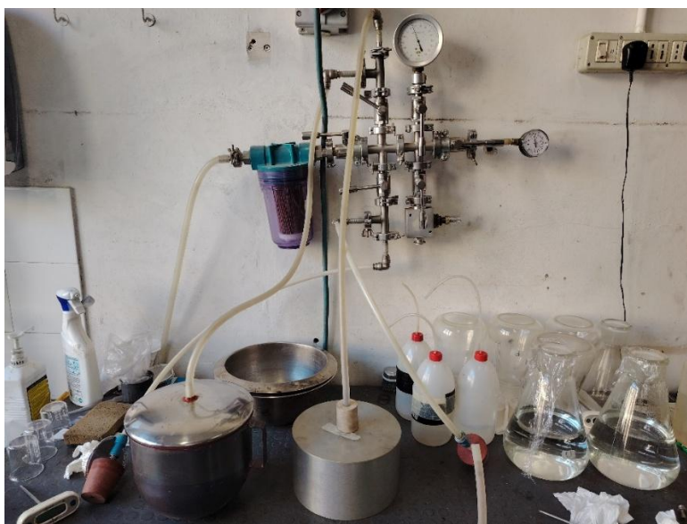
Figura 98. Sistema di deaerazione per campioni wet
