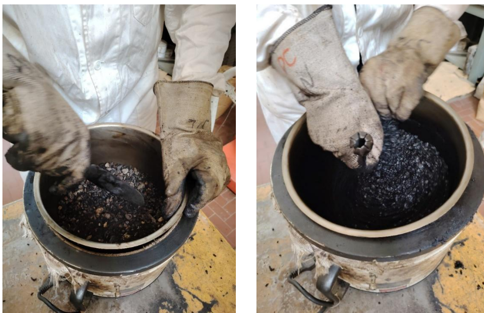
Figura 42. Miscelazione manuale di aggregati+RAP+plastica (sx) e del conglomerato finale (dx)
