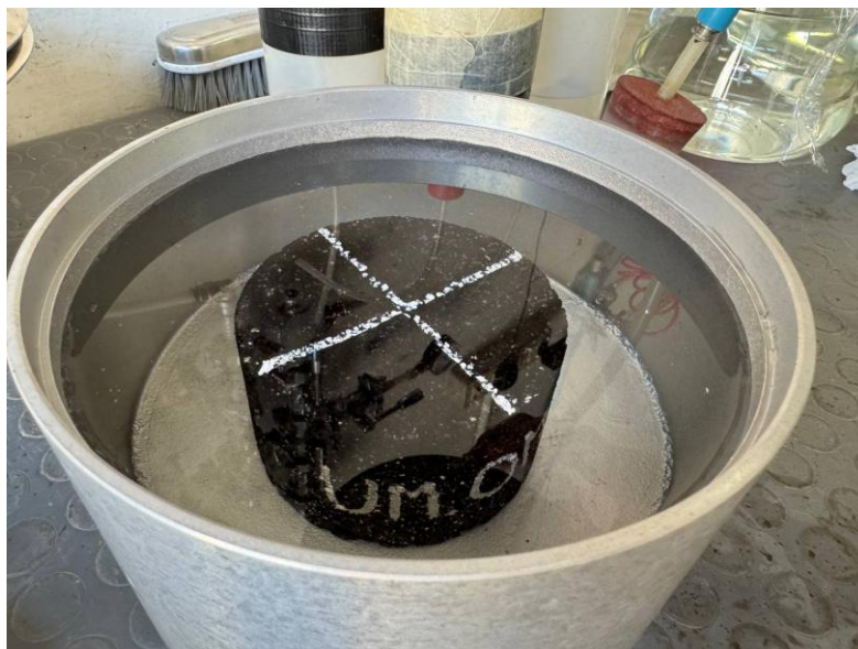
Figura 99. Campione inserito nel contenitore con acqua prima della deaerazione
