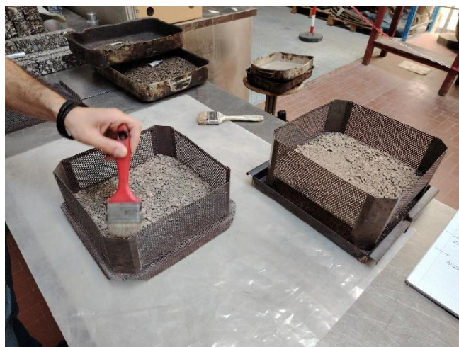
Figura 50. Pulizia degli aggregati post-ignizione
