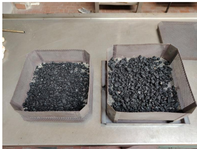
Figura 48. Conglomerato nel cestello prima del processo di ignizione
