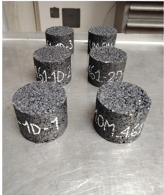
Figura 53. Proveni di conglomerato bituminoso post-compattazione
