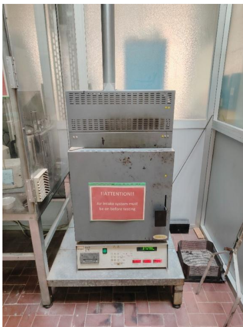
Figura 47. Carbolite utilizzata per il processo di ignizione
