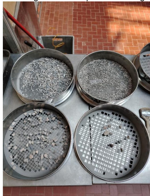
Figura 26. Trattenuto post-setacciatura ai setacci 12.5 mm, 8 mm, 4 mm, 2 mm
