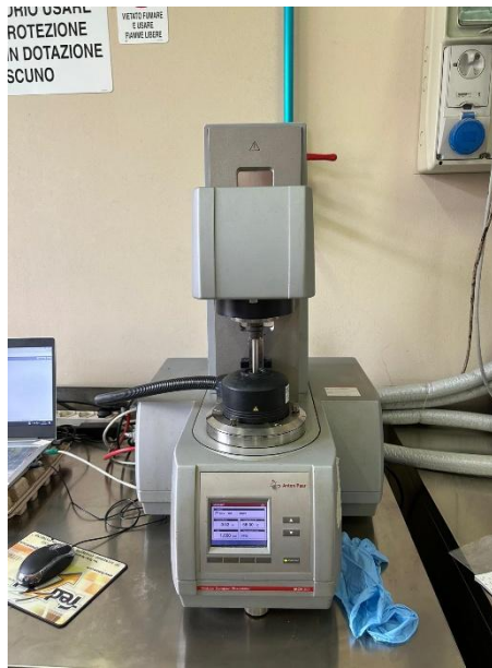
Figure 83 - DSR Aanton Paar M302
