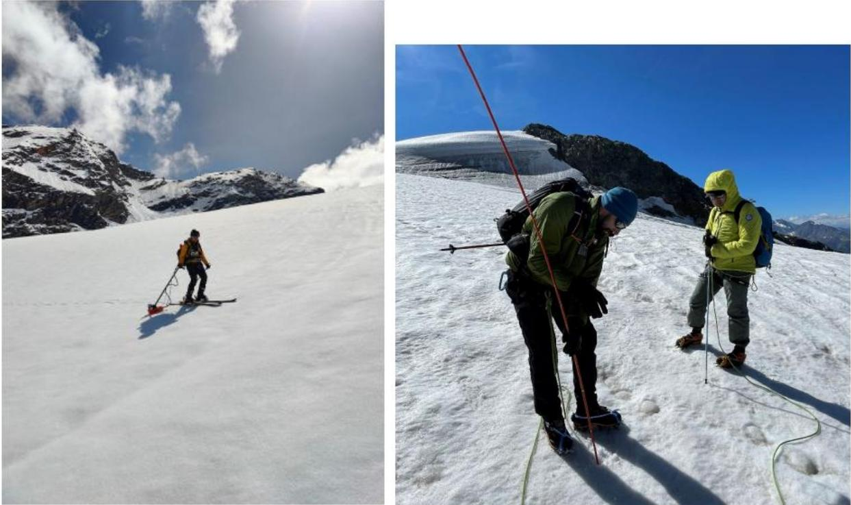
*Figura 31: Figura sinistra: Misura dell'accumulo nevoso tramite GPR- Ground Penetrating Radar effettuata dei tecnici del Politecnico di Torino – DIATI;*
