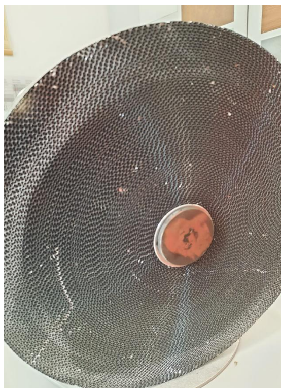
Figura 1.6 - Immagine di uno scambiatore rotativo entalpico prodotto con lega di alluminio 8006.
