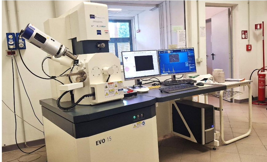
Figure 2.30. SEM Zeiss EVO 15
