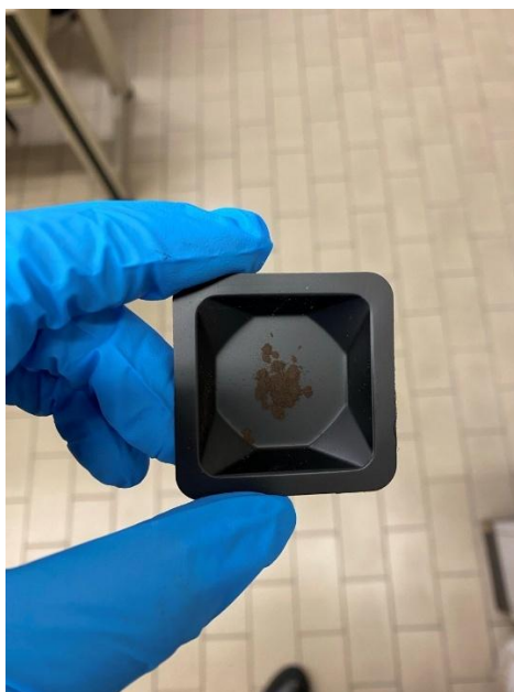
Figura 8.3: fotocatalizzatore in polvere Ce-UiO-66-NH 2
